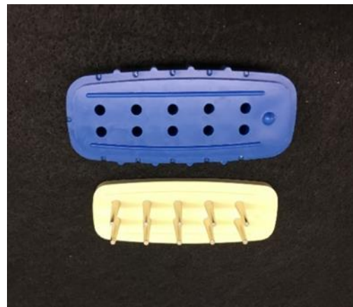
fig. 13 上部プレートが石膏で下部が樹脂素材のツインピン貼り付け模型
