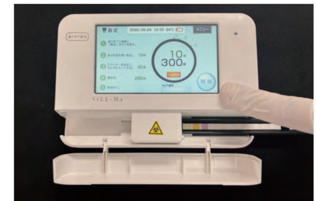
図6 唾液検査の流れ③：試験紙をセットし計測
