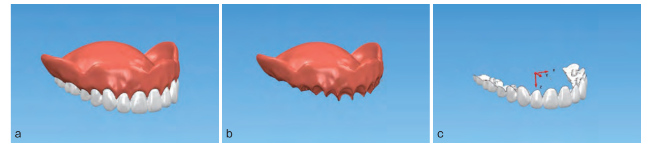
図 12-a ~ c CAD 上で義歯床部と人工歯部のデータを分離する
