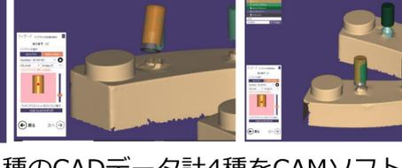
Straight 2種, Angle 2種のCADデータ計4種をCAMソフトに移行、 を基準とした時の各部位の挿入角度をCAMソフトで計算してスキャンデータの誤差がCAMソフトに与える影響を検証した。黄色い部分が角度誤差があった項目で模型②AngleのデータでX軸, Y軸を中心に挿入角度の差が表れ、CADデータは嵌合部座標に影響する事が分かった。
