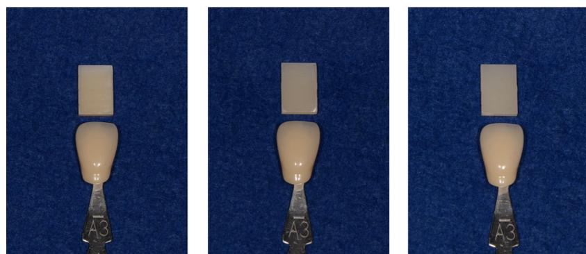
図14 焼成後の試験片(左から1350℃, 1450℃, 1550℃)
