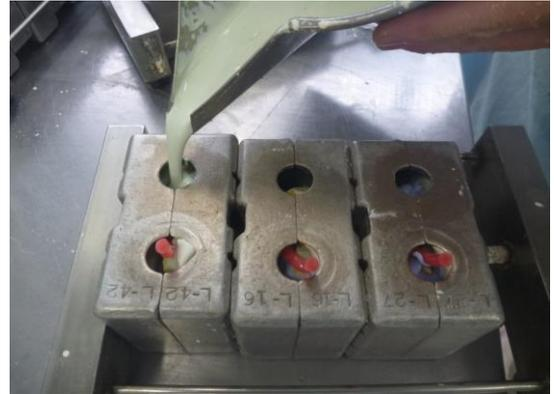
図15 フラスコをクランプで固定し、石膏を注入した。
