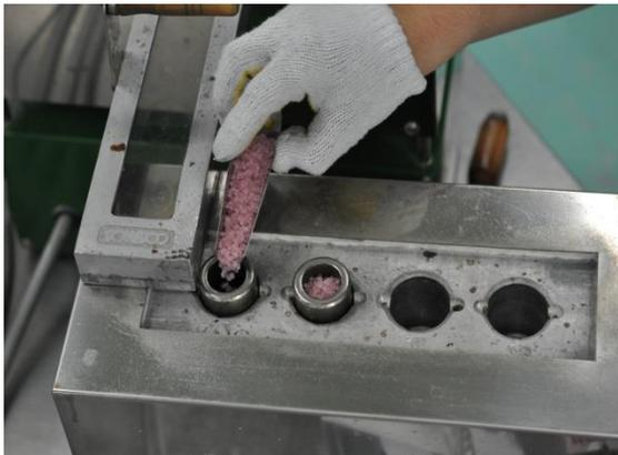
図22 熱可塑性樹脂は樹脂溶解機でメーカー指定時間溶解を行う。
