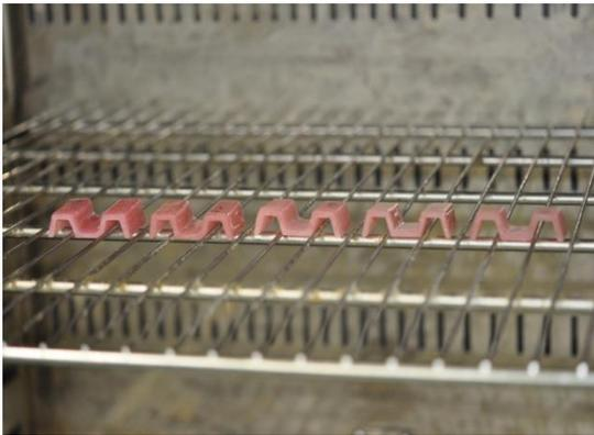
図26 乾燥機25℃に設定し、試験片を保存した。
