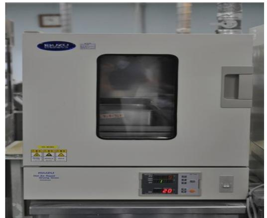
図6 熱可塑性の樹脂は乾燥機にて指定の時間乾燥させる。
